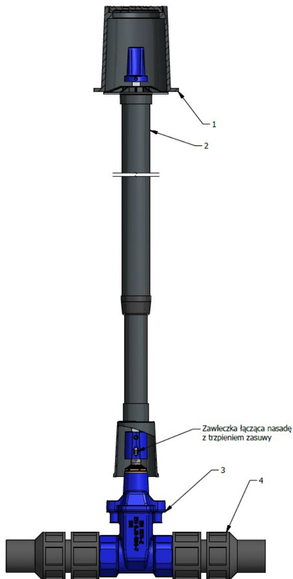
Rysunek 4. Przykładowy schemat montażowy zasuw ZG2
